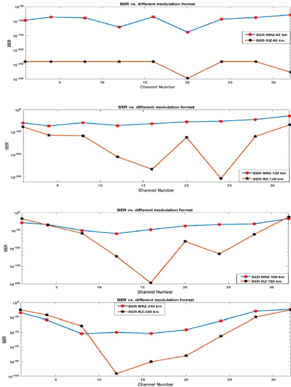
**Figure 5.6** BER Vs. Different Modulation Format (a) 60 km, (b) 120 km, (c) 180 km and (d) 240 km.
