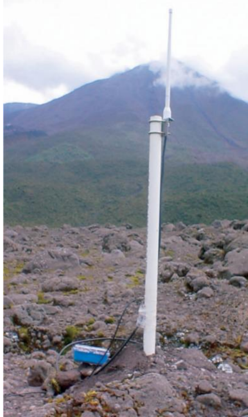
ekil 3.6 : Yanarda da kullanılan Algılayıcı Dü üm (Werner-Allen, et al., 2006)
