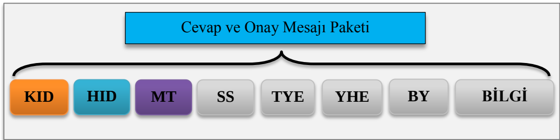
Şekil 6.24. Cevap ve Onay mesajı yapısı
