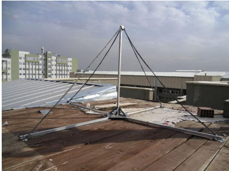
Şekil 6-4 Fırat Üniversitesi Fen Fakültesi çatısında kurulu alıcı anten
