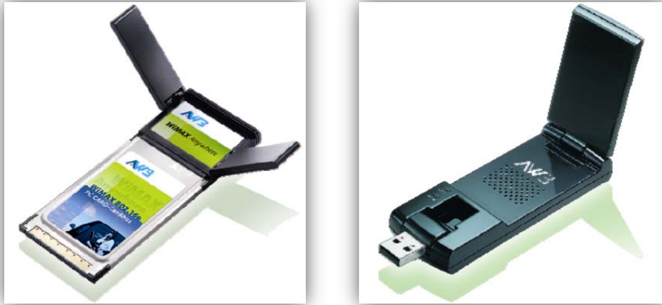
Şekil 9.14 : AWB PC200 WiMAX PCMCIA kart ve US210 WiMAX USB adaptör
