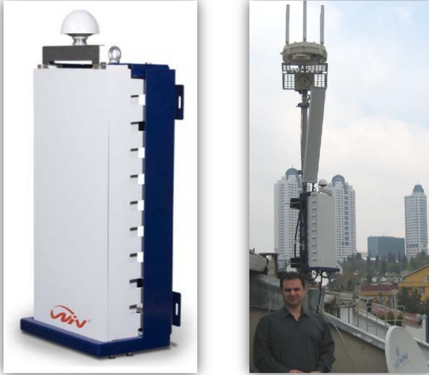
Şekil 9.12 : WiNetworks WiN7000 serisi baz istasyonu ve sahaya monte edilmiş halini
