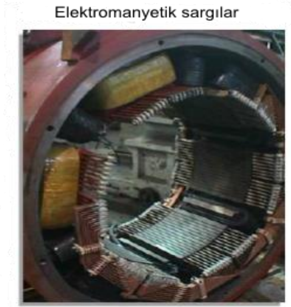
Şekil 2.5: BDC motorun statorunda elektromanyetik sargılar [28].
