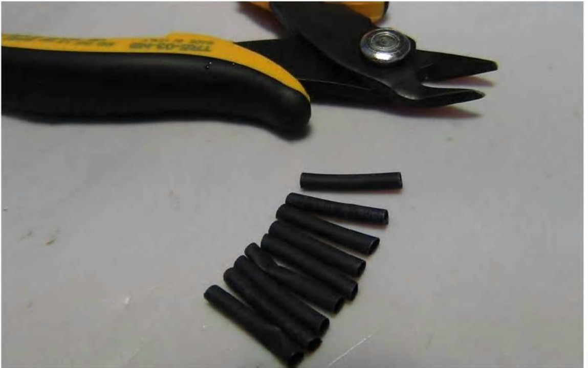
Şekil 3. 45:Yaklaşık 1cm uzunluğunda makaron hazırlıyoruz. Bir rengi karışmaması için tersine kıvrıyoruz.
