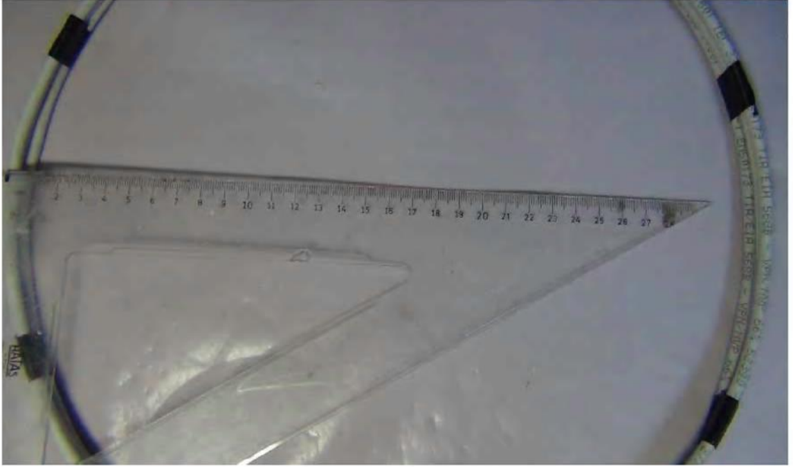
Şekil 3. 42:İlk etapta kablomuzu yaklaşık 30-35cm çapında 3 tur yuvarlak olarak sarıyoruz.
