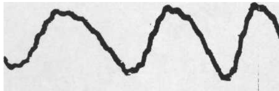
Şekil 5.22 Hat işçisinin vücudundan geçen 100 \mu A 'lık indükleme akımının dalga şekli.
