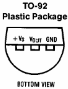
Şekil 7: LM35 bacak bağlantıları
